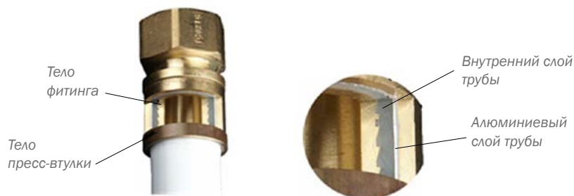
2 Соединение многослойных труб
